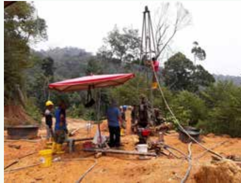
Kerja penggerudian bagi penilaian timah primer di Karangan, Kulim, Kedah
