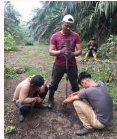
Ujian Proba mackintosh dalam kawasan Tanah Gambut Yang Sering Terbakar di Kg. Tok Kah, Dungun, Terengganu
