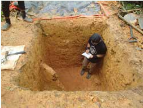
Pengelogan profil tanah daripada lelubang bagi kajian potensi emas di Sg Jenalik, Lanchang, Pahang
