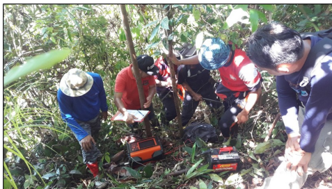
Survei geofizik kaedah transient electromagnetic (TEM) untuk kajian mineral manganese di Kg Taritipan Kota Marudu Sabah
