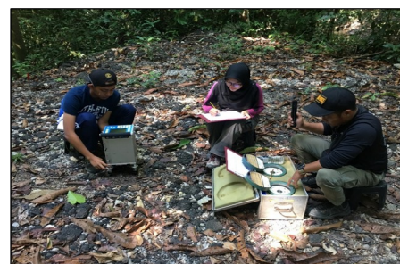
Cerapan data graviti menggunakan peralatan Gravimeter Scintrex CG5 dan cerapan data ketinggian menggunakan peralatan Barometer di Pahang
