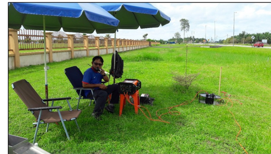
Survei keberintangan elektrik 2D yang dijalankan di Bagan Datuk, Perak.
