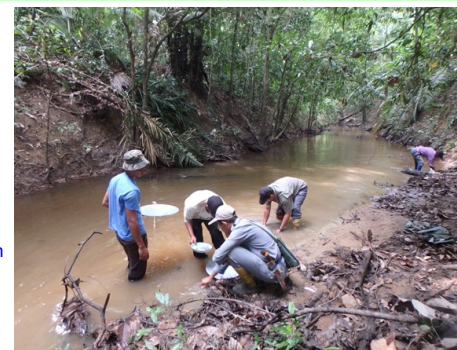
Persampelan kelodak dan konsentrat bagi kajian sumber pemineralan emas di Sg. Jenalik, Lanchang, Pahang
