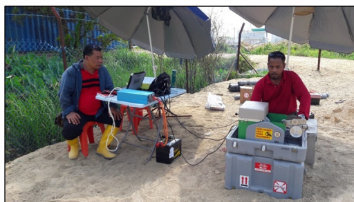
Survei penglogan geofizik untuk kajian sumber air tanah di Tunjong, Kelantan
