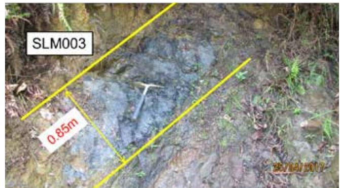
Singkapan arang batu dengan ketebalan 0.85 m di Silimponon Coal outcrop with 0.85 m thickness at Silimponon
