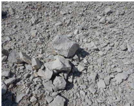
Sampel asal batuan dolomit yang digunakan untuk penghasilan marmar sintetik Dolomite rock used for the production of synthetic marble
