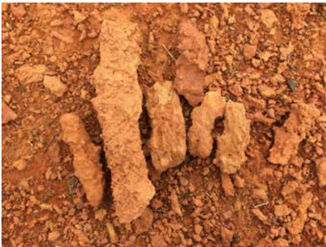
Nodul bauksit yang ditemui di Muar, Johor Bauxite nodules found in Muar, Johor
