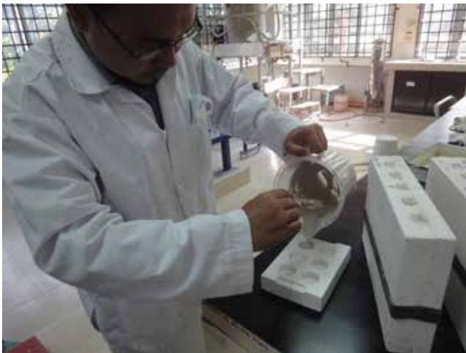
Kaedah tuangan slip digunakan untuk menghasilkan sampel bentuk bebutang Casting method slip method is used for formation of button sample
