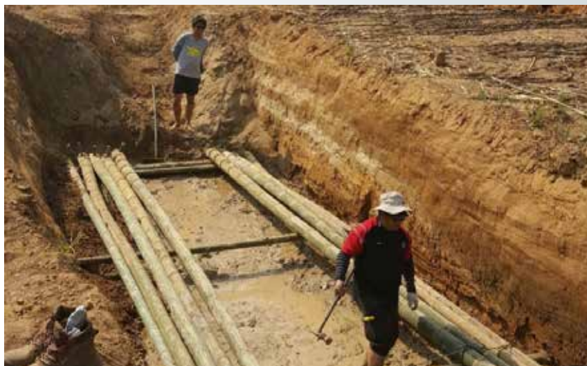
Kaedah perparitan bagi pemetaan sesar aktif Trenching method for active fault mapping
