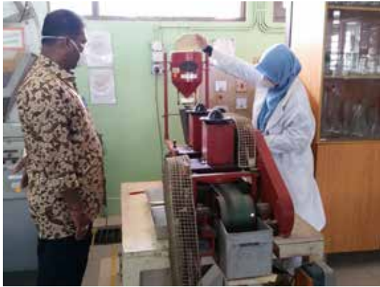
Ujian pemisahan bermagnet untuk sampel bijih besi High magnetic separation test for iron ore
