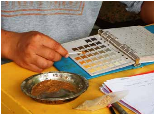
Pengkodan warna tanah menggunakan Munsell Chart Soil colour coding using Munsell Chart
