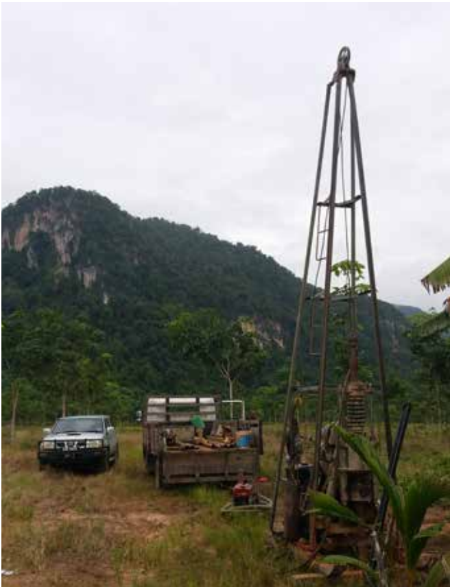
Penggerudian intan batu kapur/ dolomit di Padang Besar, Perlis Diamond drilling of limestone/ dolomite in Padang Besar, Perlis
