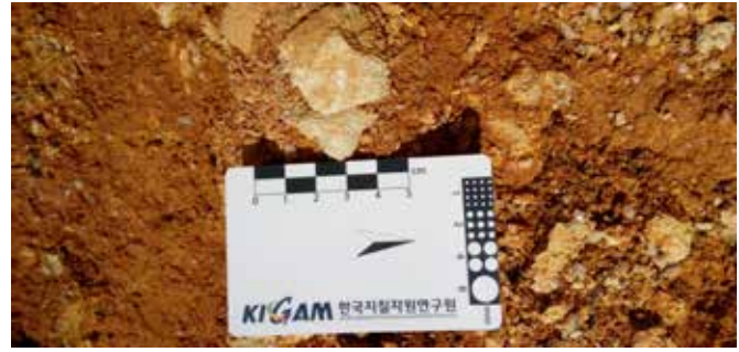
Pirofilit terluluhawa pada singkapan greisen yang mengandungi butiran kasiterit di Gunung Bongsu, Kedah
