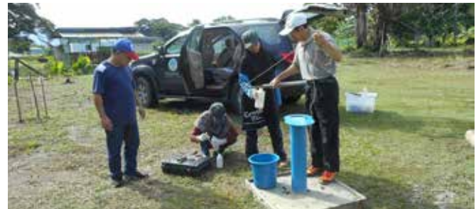
Kerja-kerja pemantauan paras air dan kualiti air bawah tanah di sekitar daerah Kota Belud. Monitoring groundwater level and water quality at Kota Belud District.
