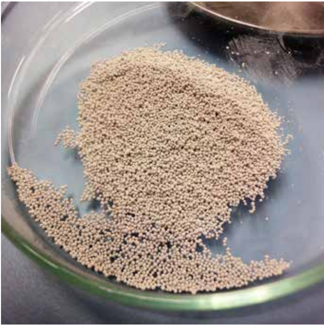
Butir-butir bahan prabakar yang dihasilkan Pre-fired granular material produced
