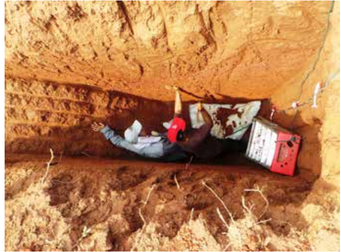
Membuat log dan persampelan bauksit dalam lelubang di Felcra Bt. Segumpal Maran, Pahang Logging and sampling for bauxite in a trial pit at Felcra Bt. Segumpal Maran, Pahang
