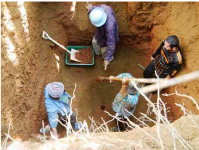
Pengerimitan untuk menentukan ketebalan lapisan bauksit di Lembah Jabor, Kemaman Hand augering to determine thickness of the bauxite layer at Lembah Jabor, Kemaman
