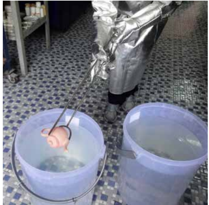
Ujian tahan kejutan haba sedang dijalankan Anti-thermal shock testing
