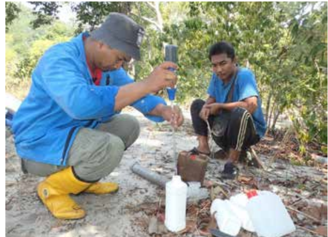
Persampelan air tanah yang dijalankan di Pulau Redang, Terengganu Groundwater sampling at Pulau Redang, Terengganu
