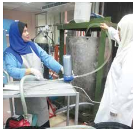
Larutan ionik bersukrosa ditapis dan dimasukkan terus ke dalam tangki penyediaan PCC bagi kajian cat Ionic sucrose solution is filtered and fed directly into PCC preparation tank for paint formulation
