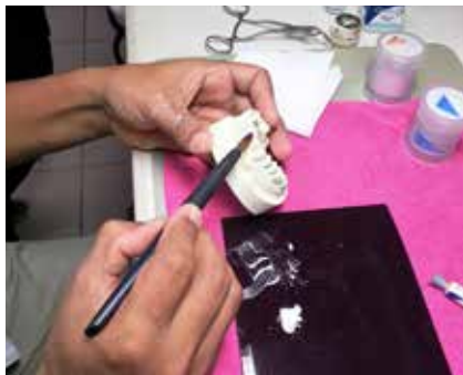
Ujian kebolehcuan ke atas kaca-seramik leusit Moldability test of leucite glass-ceramics
