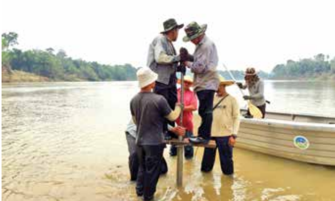
Persampelan pasir sungai dengan kaedah penggerimitan di Sungai Pahang, Temerloh, Pahang River sand sampling using augering method at Sungai Pahang, Temerloh, Pahang
