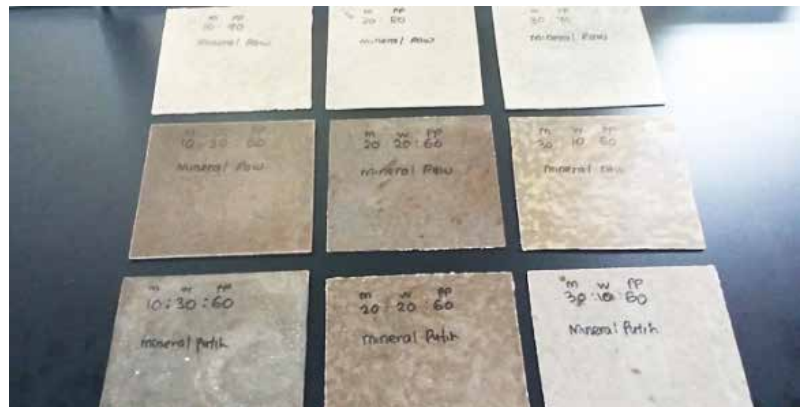
Produk komposit kayu-plastik yang dihasilkan dengan menggunakan kalsium silikat sebagai pengisi Wood-plastic composite products produced using calcium silicate as a filler
