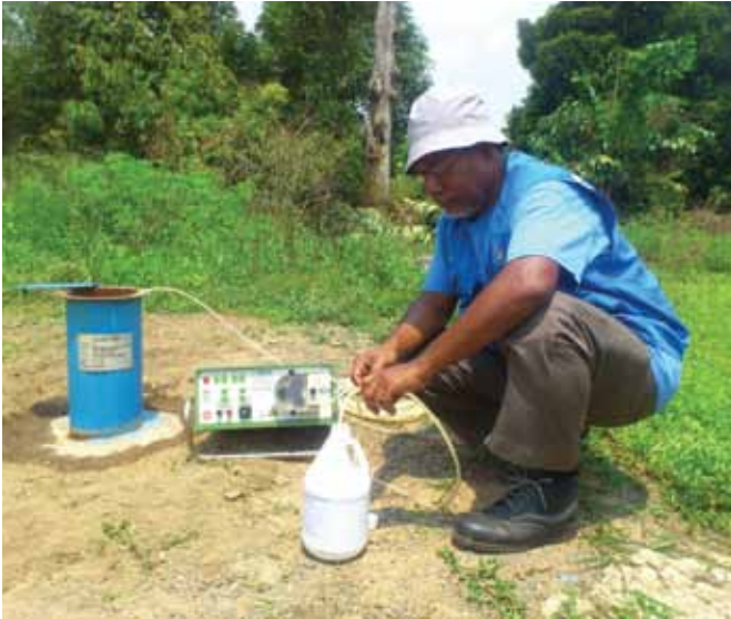
Pengambilan sampel air bawah tanah menggunakan peristaltic pump di Kg. Semerbok, Rembau, Negeri Sembilan. Taking groundwater samples using a peristaltic pump at Kg. Semerbok, Rembau, Negeri Sembilan.
