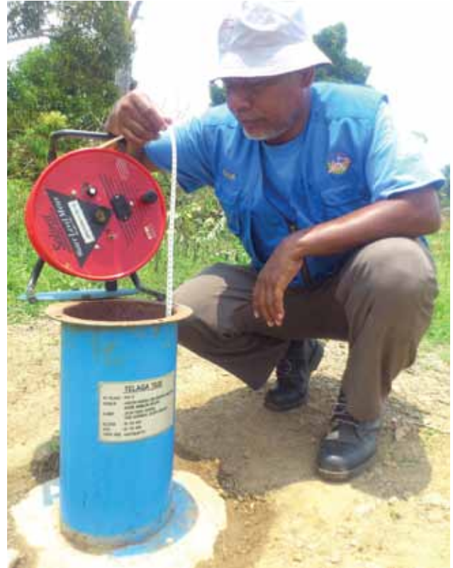
Pengukuran paras air bawah tanah di Kg. Semerbok, Rembau, Negeri Sembilan. Groundwater level measurement at Kg. Semerbok, Rembau, Negeri Sembilan.
