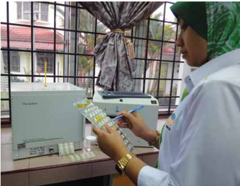
Pengukuran E.coli dalam sampel air bawah tanah menggunakan kaedah colilert. Measurement of E. coli in groundwater samples using colilert.
